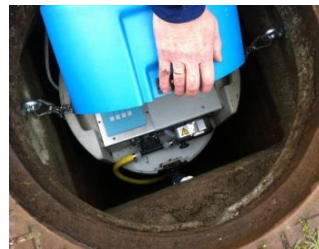
Bemonstering van een hemelwaterput met een Liquidport 2010 CSP44 monstername-unit
