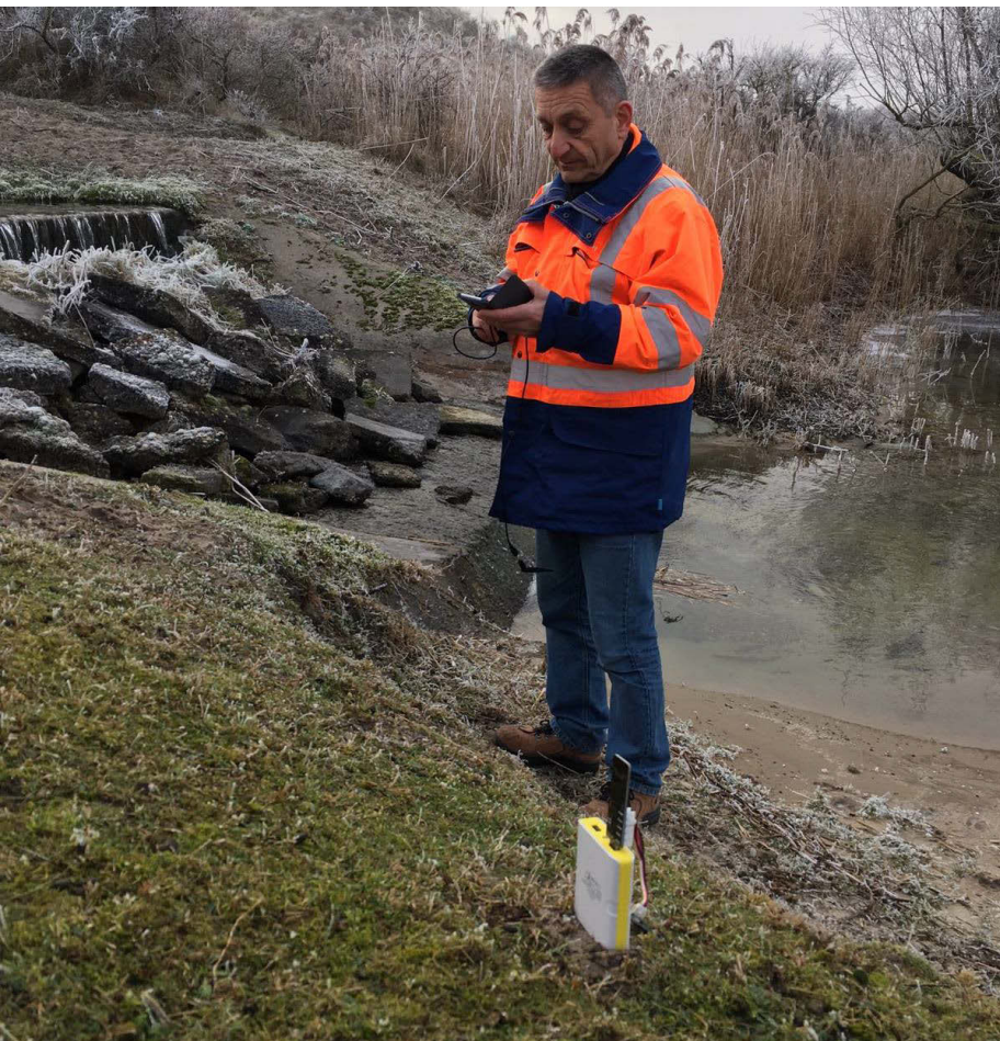
Test dekking Lorawan in de duinen, Foto: Pieter Nijdam
