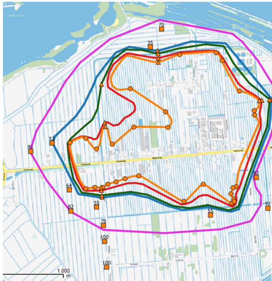
De zoet-zoutgrens in de Horstermeerpolder op verschillende diepten, in het midden van de polder zit de zoet-zoutgrens dichterbij het maaiveld dan aan de buitenkant
