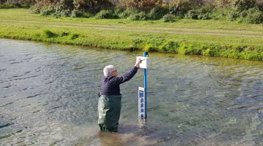
Installeren waterniveaumeting met LPWAN
