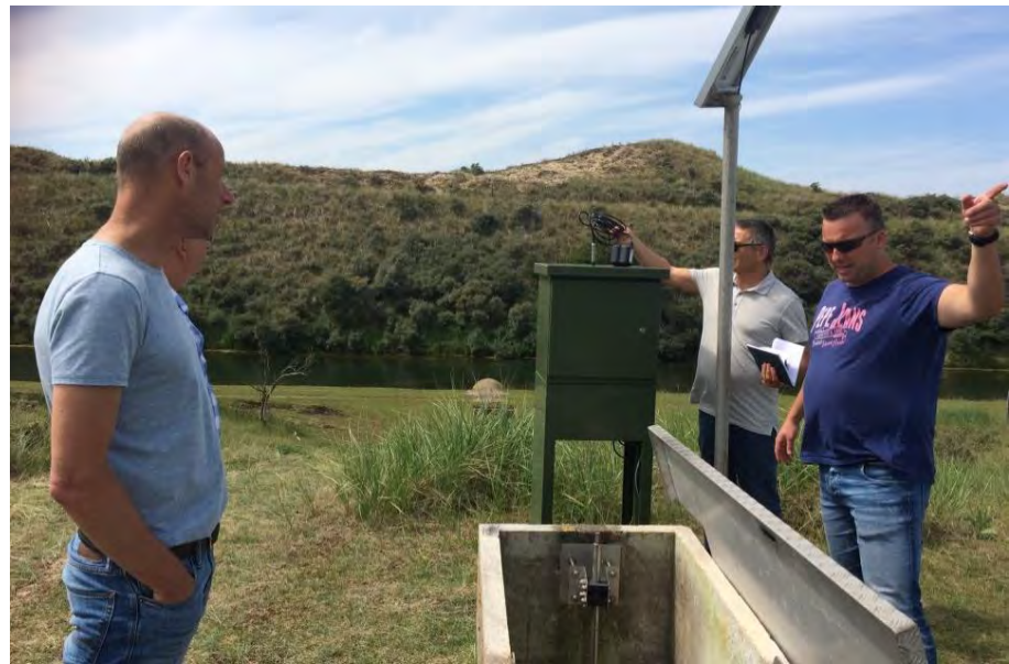
Testen van oppervlaktewater- en grondwatermetingen via LPWAN in de Amsterdamse Waterleidingduinen
